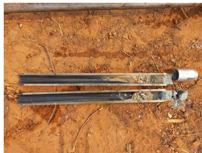
Foto 6 - Transição cascalho c/ seixos p/ rocha alterada
