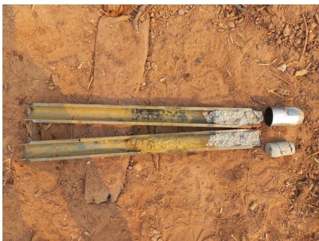
Foto 5 - Transição da areia fina amarelada p/ argila branca siltosa
