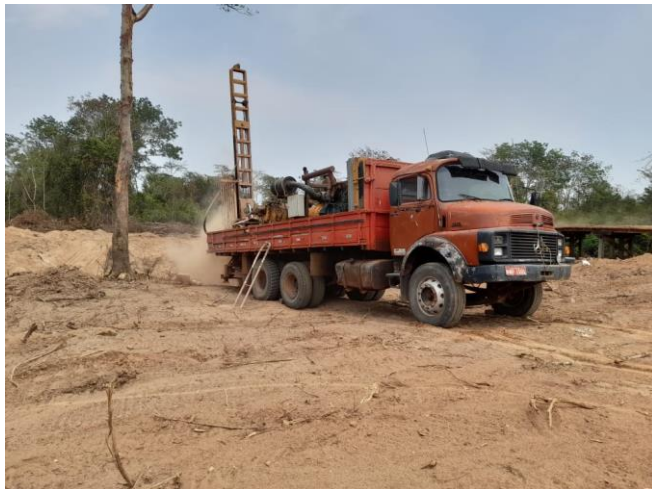
Foto 7 - Sonda rotopneumática
